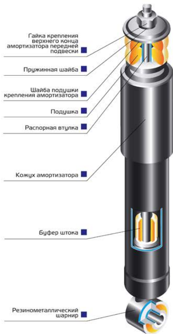
Амортизатор задней подвески в разрезе
